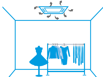
Rozkład powietrza z zabrudzonym filtrem
