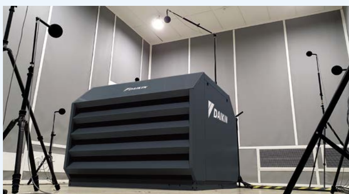
Pomiar poziomu mocy akustycznej w komorze akustycznej
