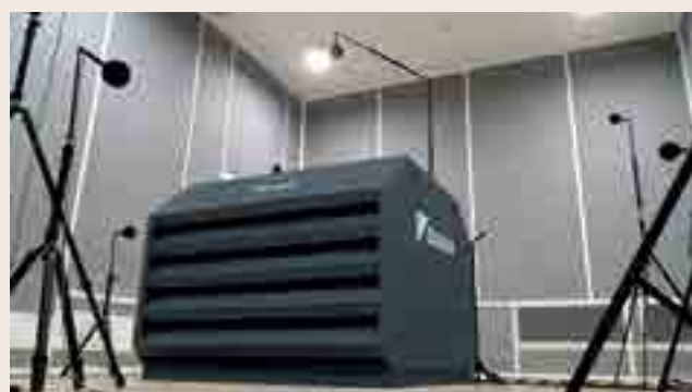
Pomiar poziomu mocy akustycznej w komorze akustycznej
